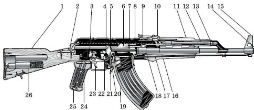
Рис. 10. Устройство автомата: 1 – приклад; 2 – выступ направляющего стержня возвратного механизма; 3 – переводчик; 4 – крышка ствольной коробки; 5 – курок; 6 – затворная рама; 7 – ударник; 8 – затвор; 9 – прицельная планка; 10 – колодка прицела; 11 – ствольная накладка; 12 – газовый поршень; 13 – газовая трубка; 14 – муфта ствола; 15 – основание мушки; 16 – цевье; 17 – шомпол; 18 – ствол; 19 – магазин; 20 – защелка магазина; 21 – боевая пружина; 22 – рычаг автопуска; 23 – спусковой крючок; 24 – пистолетная рукоятка; 25 – соединительный винт; 26 – принадлежность
